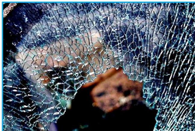
**Rotura Espontánea:** La rotura espontánea de un vidrio templado no es considerada como un defecto de fabricación, debido a que está expuesto a esto en cualquier momento de su vida útil, debido a la presencia de partículas inestables de Sulfuro de Níquel (NiS), las cuales no pueden ser detectadas ni eliminadas antes del templado. Estas partículas se encuentran por naturaleza presentes en los insumos utilizados para la fabricación de la plancha de vidrio flotado.
